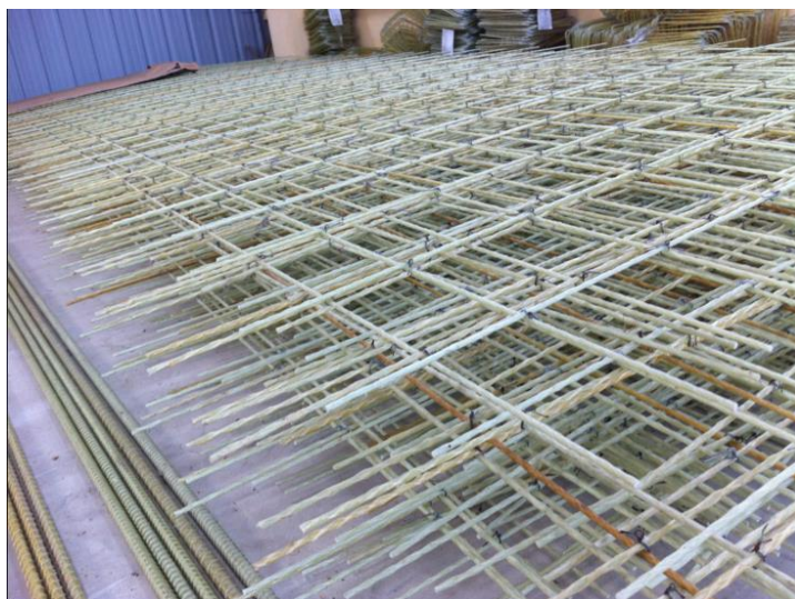
Hình 3.10: Cốt composite polyme thay thế cốt thép
